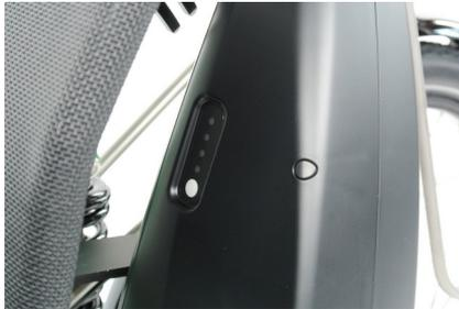
Betätigen Sie die LED-Taste zum Einschalten des Akkupacks. Die fünf LED der Ladezustandsanzeige sollten nun für ca. 4 Sekunden den aktuellen Ladezustand anzeigen. Dabei entspricht jede LED etwa 20 % Kapazität. Bei vollständig geladenem Akkupack leuchten alle fünf LED. Liegt die Kapazität des Akkupacks unter 10 %, blinkt die erste LED der Ladezustandsanzeige.
