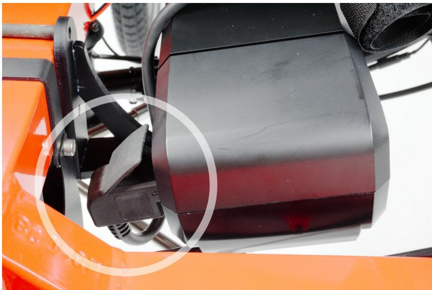
Wenn der Akku im Akkuhalter am Fahrzeug ist, stecken Sie den Ladestecker direkt, ohne Adapter, in die Ladebuchse.
